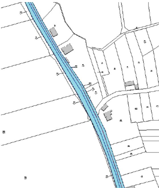
Sicherung der Befahrbarkeit mind. 1 Fahrspur durch mobile Schutzanlagen geplant, Elemente Ø 70 cm/Schutzhöhe 60 cm, ca. 180 m, Erwerb nach Förderzusage durch den Freistaat
